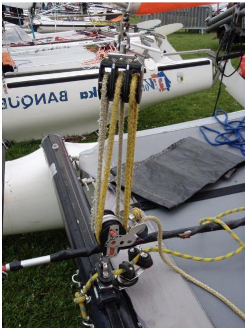
Détail du palan de GV
